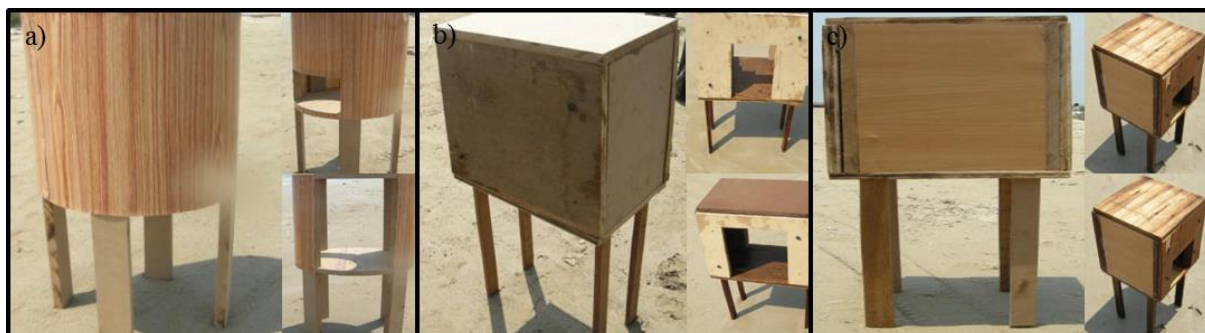
Abb. 4.12: Modellhäuser der ersten Versuchsreihe (Meyyappan, et al., 2013): a) rundes Modell, b) rechteckiges Modell c) quadratisches Modell
