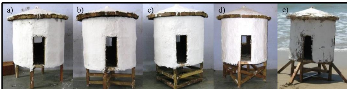
Abb. 4.14: Modellhäuser der zweiten Versuchsreihe mit unterschiedlichen Gründungstypen, geordnet nach steigender Widerstandsfähigkeit von links nach rechts (Meyyappan, et al., 2013)
