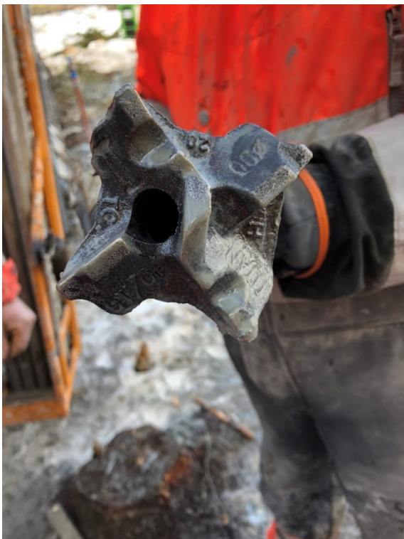
Figur 11 a) Kryssborkrone drill drain \varnothing 90 med 19 mm spylehol. b) Honda VX15 og sandfilter for pumping av vatn ned til 6-8 m djup.
