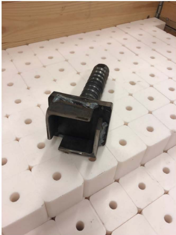
Figur 17 a) KCl-kubar og adapter for totalsonderingsstenger. b) Stempel med wire i enden av KCl-stavane. Stavane er gjenga i endane for enkel montering på staden.
