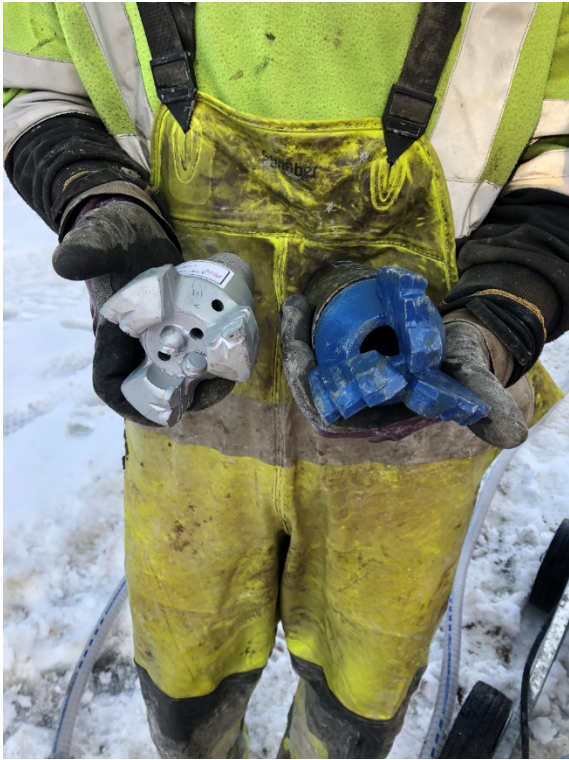
Figur 22 Ulike borkroner som verte nytta ved boring med Sonic rigg. PDC-bit til venstre og Wolfram-karbid Chevron dragbit til høgre.
