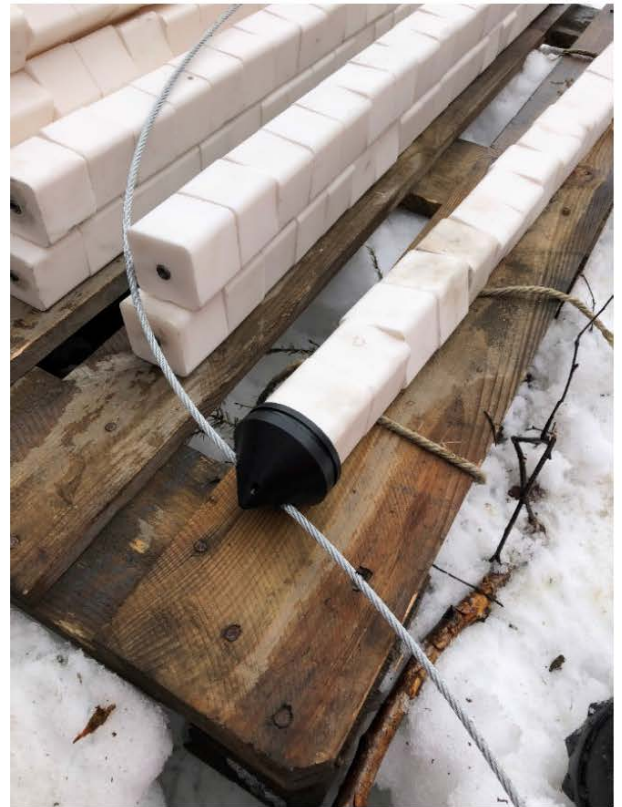
Figur 17 a) KCl-kubar og adapter for totalsonderingsstenger. b) Stempel med wire i enden av KCl-stavane. Stavane er gjenga i endane for enkel montering på staden.
