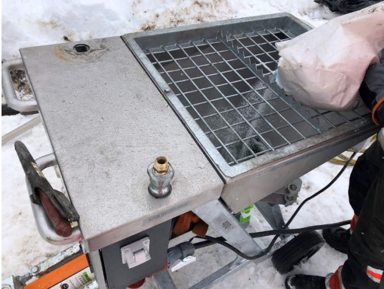
Figur 7 Tørt salt hellast ned i skruen i MAI-pumpa og blandast med vatn på veg ut av pumpa (nedst til venstre).
