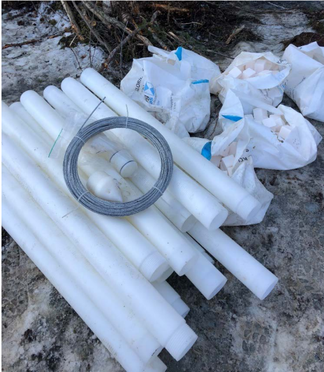
Figur 18 Ø90 mm perforerte PE-miljøbrønnerør og KCl-kubar før installasjon.
