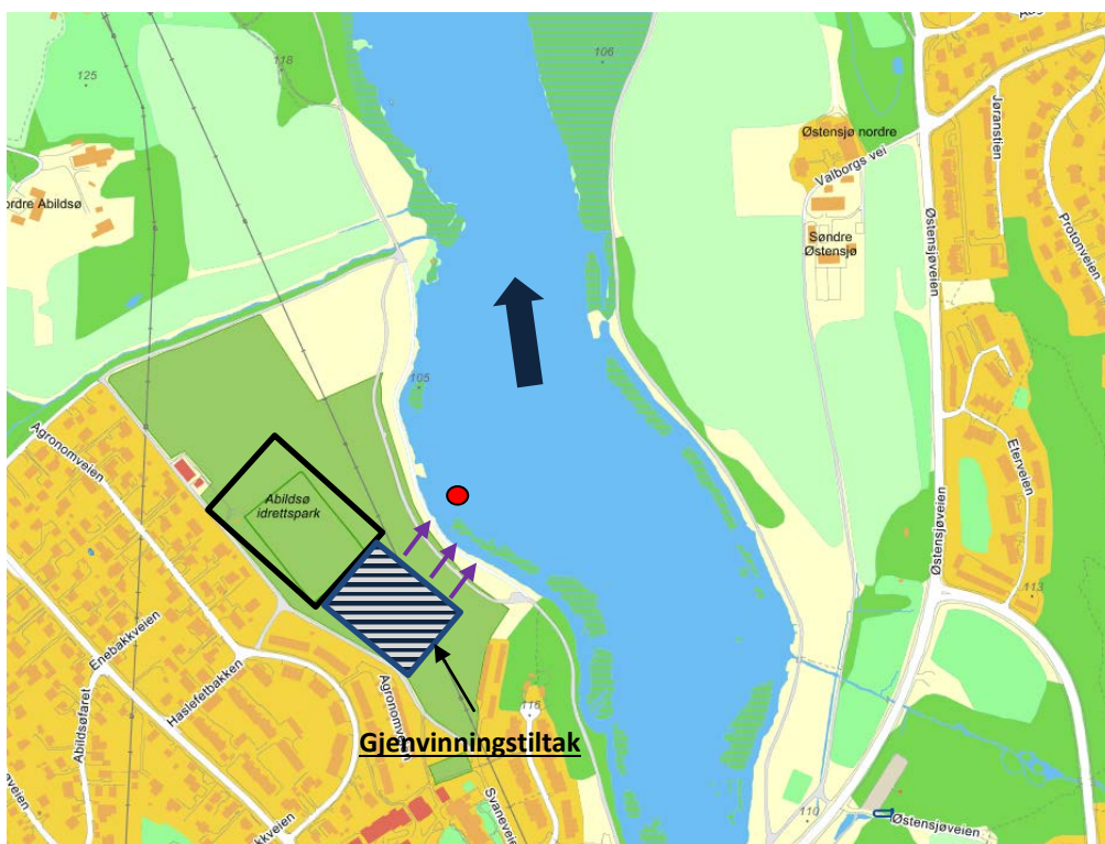
Figur 9 Kart over hypotetisk gjenvinningstiltak. Oppmerket område for planlagt støyvoll (blå rektangel). Lilla piler indikerer grunnvannsretning og rød sirkel samlepunkt for overflatevann og grunnvann nedstrøms gjenvinningstiltaket. Svart pil indikerer strømningsretning i resipient.
